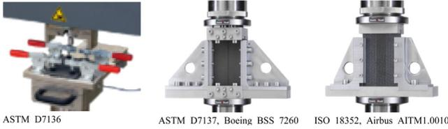
Figure 16. Test fixture for CAI test (Source : ZwickRoell).
