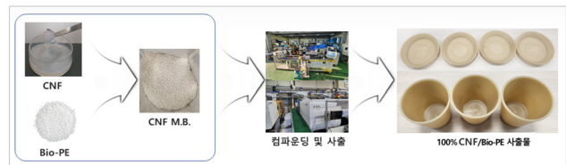
Figure 12. 100% 바이오 기반 플라스틱 복합소재 생산 및 사출.
