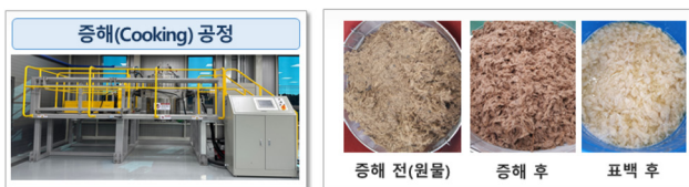
Figure 3. 대용량 증해기를 활용한 셀룰로스 원료화 과정.
