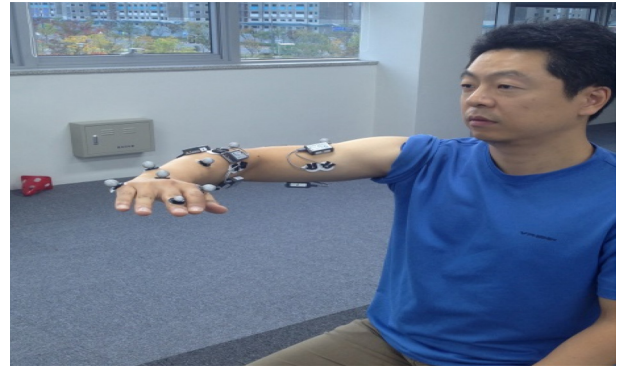
Figure 5. 상지동작 분석을 위해 적외선 마커와 무선 근전도를 동시에 측정하는 모습.
