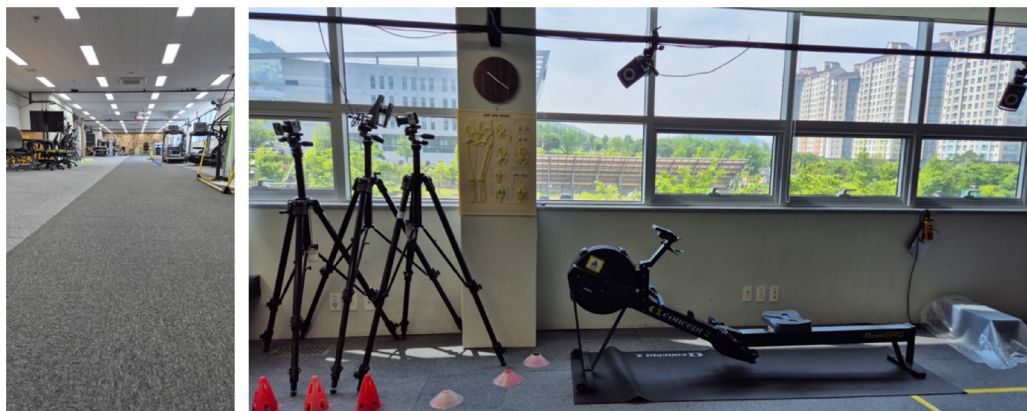
Figure 1. 동작분석 장치가 설치된 길이 37 m의 보행로(좌), Vicon 카메라와 로잉머신(우).
