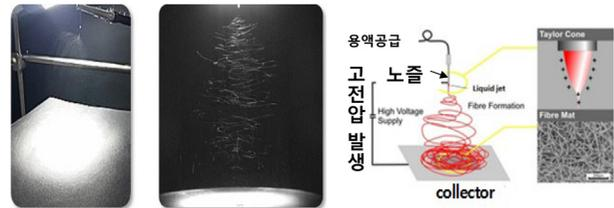
Figure 1. 전기방사 사진(좌), 모식도(우).
