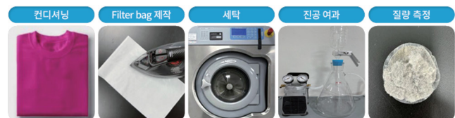
Figure 8. ISO 4484-3 시험 절차. (출처: FITI시험연구원 미세플라스틱 시험 홍보자료)
