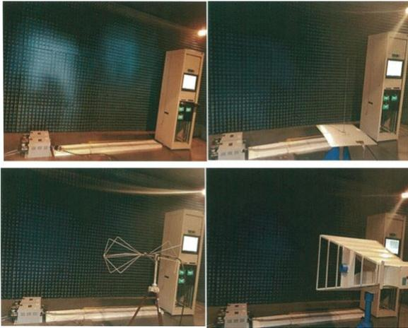
Fig. 2. Electromagnetic compatibility test (CE101, CE102, RE101, RE102)
