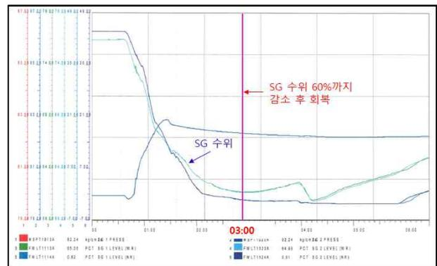
Fig. 2. CASE B : RPCS Manual actuation
