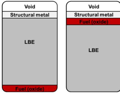
(d) 3-layer ox. immersed (e) 3-layer ox. floated
