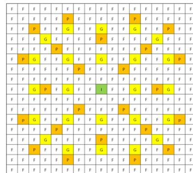
\* F : fuel pin (240), P : BA pin (24), I : instrument tube (1), G : guide tube (24)
