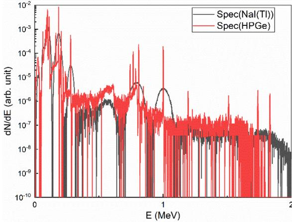
Fig. 3. Gamma spectrum of a pure  $UO_2$  pellet (4.5 wt%  $^{235}U$ ).
