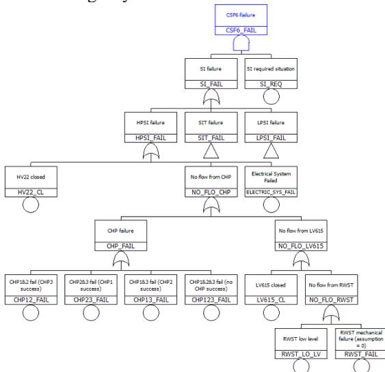
Fig. 4. CSF6 Logic Diagram
